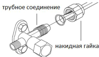
4. Затяните накидную гайку динамометрическим ключом, следуя указаниям, приведенным ниже.
