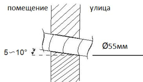
2. Сделайте отверстие для трубы диаметром Ø55мм на выбранном месте выхода трубы. Для обеспечения плавного слива наклоните отверстие для трубы на стене немного вниз к наружной стороне с уклоном 5-10°.
