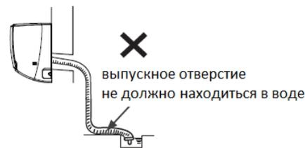
Дренажный шланг следует слегка наклонить вниз. Дренажный шланг не должен быть искривлен, приподнят, изогнут и т. д.
