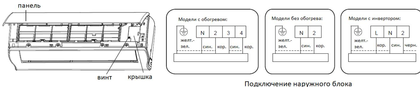
2. Пропустите провод питания через отверстие для поперечного кабеля на задней стороне внутреннего блока, а затем вытяните его с передней стороны.
