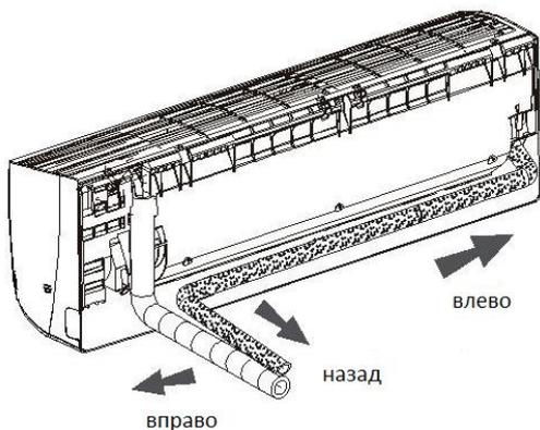
2. При выборе вывода трубы слева или справа, пожалуйста, вырежьте соответствующее отверстие в нижней части корпуса.
